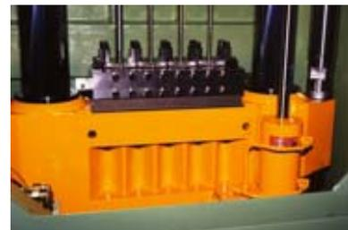
Automatische Werkstückzuführung sind für Großmengenfertigung üblich und sind individuell entsprechend dem Einzelfall konstruiert. Es bestehen vielfältige Lösungen, bei denen die unterschiedlichen Bedingungen der Werkstückein- und ausgabe berücksichtigt sind. Darüber hinaus kann eine Verkettung oder die Vorbereitung für eine solche (z. B. Signalaustausch) vorgesehen werden.
